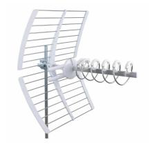
Antenne hélicoïdale de bande UHF avec connecteur F, continuité de la technologie Loop Yagi adoptée par Fracarro Eléments prémontés, dipôle et réflecteurs à insertion rapide et fixation au mât avec réglage vertical de série avec vis papillon pour le montage sans outils.
